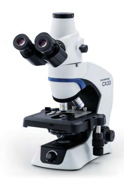
Микроскоп для наблюдений в проходящем свете по методу светлого поля (допонительно: темное поле с объективами числовой апертурой до 0.65).
